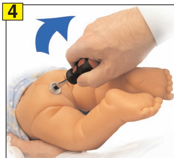
Завернуть контакт-заглушку. Если элементы питания установлены правильно на 1 секунду загорится зелёный индикатор.
